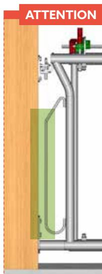
Pour un montage poteau de charpente et poteau bois, l'ouverture du double cadre au maximum impose une zone de sécurité pour les mains et conserve un espace permettant l'ouverture. Ainsi, l'encombrement intérieur poteau nécessite jusqu'à 150 mm de plus que la longueur nominale.
