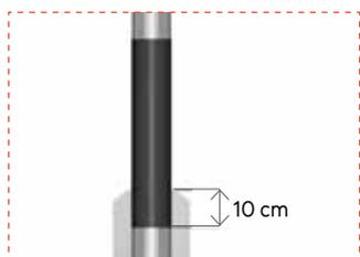
Adapter la hauteur de la chaussette au niveau de la zone de contact, 10 cm en dessous du béton, et laisser le poteau en métal scellé en contact direct avec le béton.
