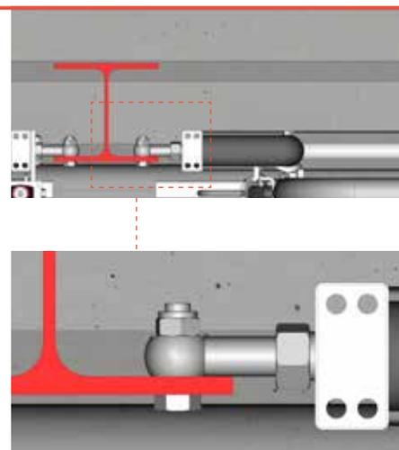
Il est déconseillé de monter le panneau d'une manière rigide en boulonnant les tiges à œil directement sur le poteau.
